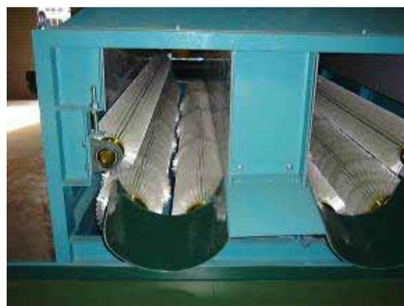
専用特殊ブラシの採用で、ブラシの谷間に落ち込んだ状態で、多く回転を加えながら磨きをかけ、また細かな部分も磨けるようブラシの毛足を長くしたリングブラシも採用して、より多く接触させることにより、艶のある仕上がりとなります。
