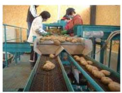
小玉抜き機、粗選別コンベヤなどを組み合わせることで処理能力はさらに向上します。
